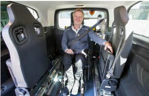
Ein **Dreipunktgurt** sorgt für optimale Sicherung.
